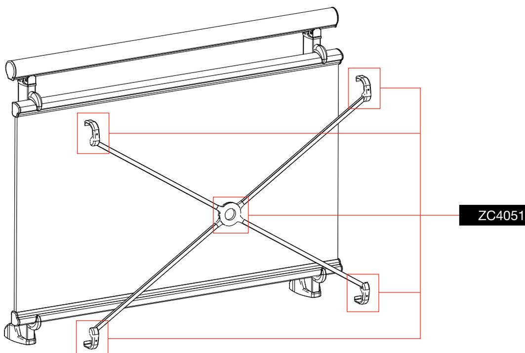
La cruz de S. Andrés se puede aplicar sólo a los tipos con elemento de relleno de cristal unido a un travesaño superior e inferior.
