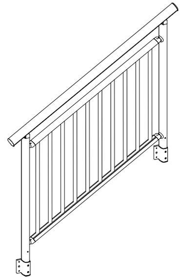
Tipo de fijación frente losa
