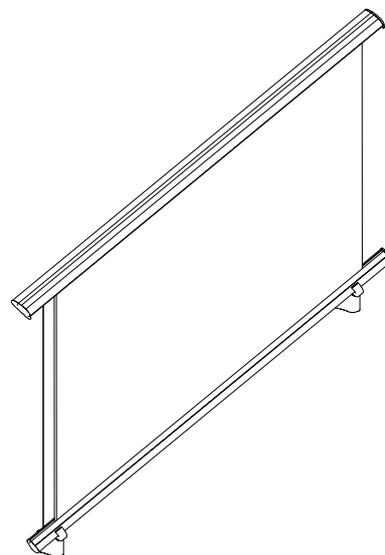
Tipo de fijación encima de losa
